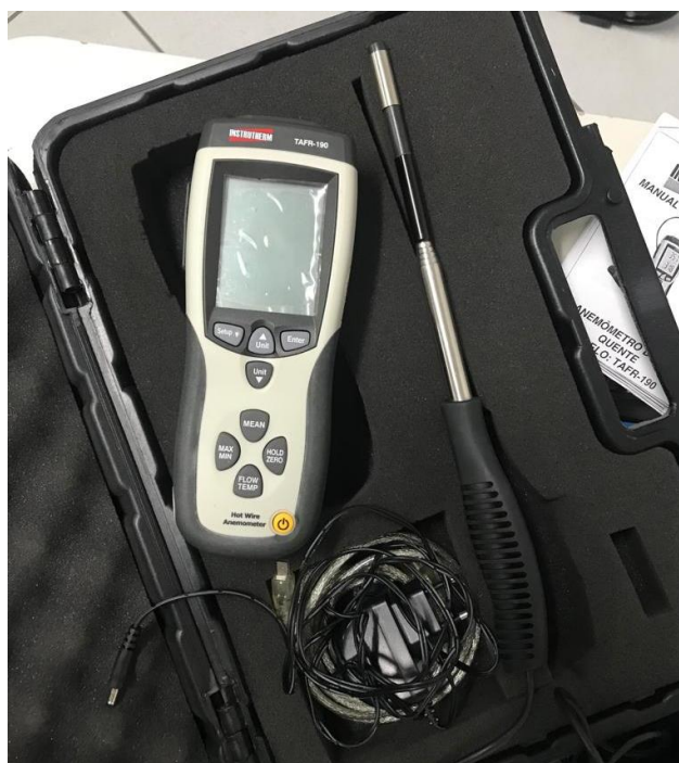
Figura 11: Sensor TAFR-190 Anemômetro de fio quente
