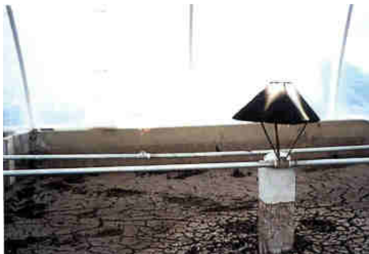
Figura 23: Método de secagem do lodo adotado por Ferreira (2001)
