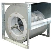
Ventilador centrífugo tipo Airfoil, de dupla aspiração, com quadros de reforço, para acionamento por transmissão marca Soler\_Palau modelo RFD-Q 1000 ARR.3 CL.II POSIÇÃO H180 W 1000rpm - 40cv 4POLOS 3-220/380V-60Hz para uma vazão 58.433 m<sup>3</sup>/h e uma pressão estática 1.377 Pa.
