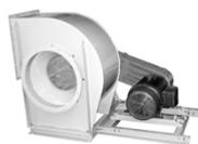
Ventilador centrífugo industrial tipo Airfoil, com rotor em balanço, de simples aspiração, para acionamento por transmissão marca Soler\_Palau modelo RFS 1250 ARR.1 CL.III POSIÇÃO H180 W 1100rpm - 100cv 4POLOS 3-220/380V-60Hz para uma vazão 62.699 m<sup>3</sup>/h e uma pressão estática 2.622 Pa.
