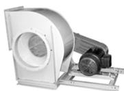
Ventilador centrífugo industrial tipo Airfoil, com rotor em balanço, de simples aspiração, para acionamento por transmissão marca Soler\_Palau modelo RFS 315 ARR.1 CL.II POSIÇÃO H180 W 3300rpm - 3cv 4POLOS 3-220/380V-60Hz para uma vazão 3.094 m<sup>3</sup>/h e uma pressão estática 1.474 Pa.
