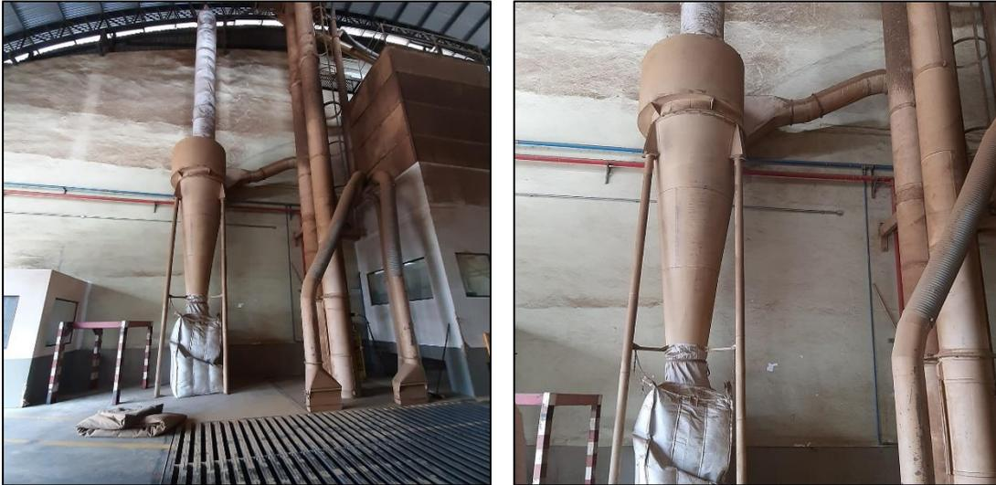
**Figura 4.4 – Local de descarga da colheita do café e o ciclone utilizado.**
