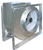
Ventilador centrífugo tipo limit load de baixa vazão, de simples aspiração, com quadros de reforço, para acionamento por transmissão marca Soler\_Palau modelo LMS-Q 400 ARR.3 CLI POSIÇÃO H180 W 3100rpm - 4cv 4POLOS 3-220/380V-60Hz para uma vazão 3.090 m<sup>3</sup>/h e uma pressão estática 2.378 Pa.
