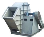
Ventilador centrífugo industrial tipo limit load de baixa vazão, com rotor em balanço, de simples aspiração, para acionamento por transmissão marca Soler\_Palau modelo LMS 400 ARR.1 CL.II POSIÇÃO H180 W 3700rpm - 7.5cv 4POLOS 3-220/380V-60Hz para uma vazão 3.055 m<sup>3</sup>/h e uma pressão estática 3.595 Pa.
