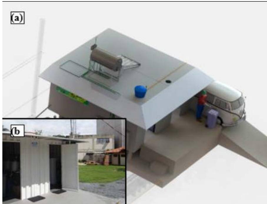
Figura 3-11: Plataforma de recepção da Fração Orgânica de Resíduos Sólidos Urbanos (FORSU), onde: a) desenho esquemático; b) vista geral da plataforma de recepção.
