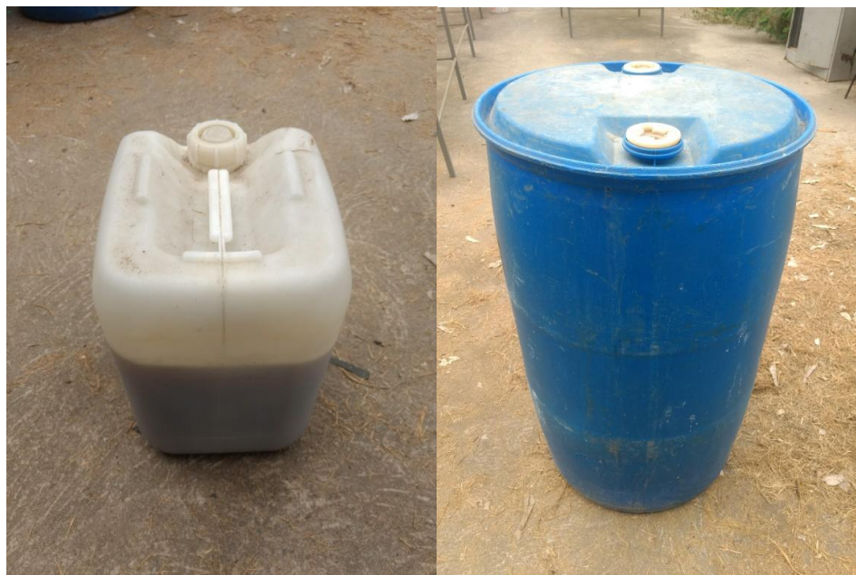
Figura 17 - Bombona de 20 litros utilizada no transporte da urina (esquerda) e bombona de 200 litros utilizado para o armazenamento da urina coletada (direita)
