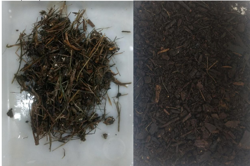
Figura 48 - Amostra inicial do material de L1 (esquerda) e amostra final do composto obtido de L1 (direita)
