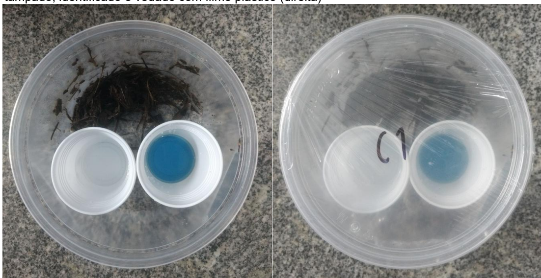
Figura 28 - Pote de incubação contendo a amostra, um recipiente com a solução de NaOH e outro com a solução indicadora de ácido bórico (esquerda) e o mesmo pote de incubação tampado, identificado e vedado com filme plástico (direita)
