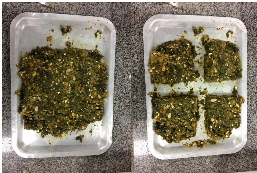
Figura 19 - Amostra de resíduo misturada após o descongelamento (esquerda) e quarteamento inicial para retirada de amostra representativa (direita)
