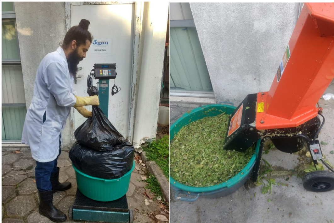
Figura 11 - Pesagem dos resíduos coletados (esquerda) e posterior trituração (direita)
