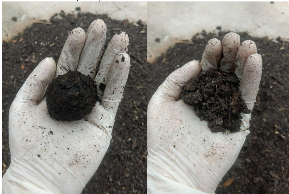
Figura 25 - "Teste da mão": Material com umidade adequada (esquerda) e material com baixo teor de umidade (direita)
