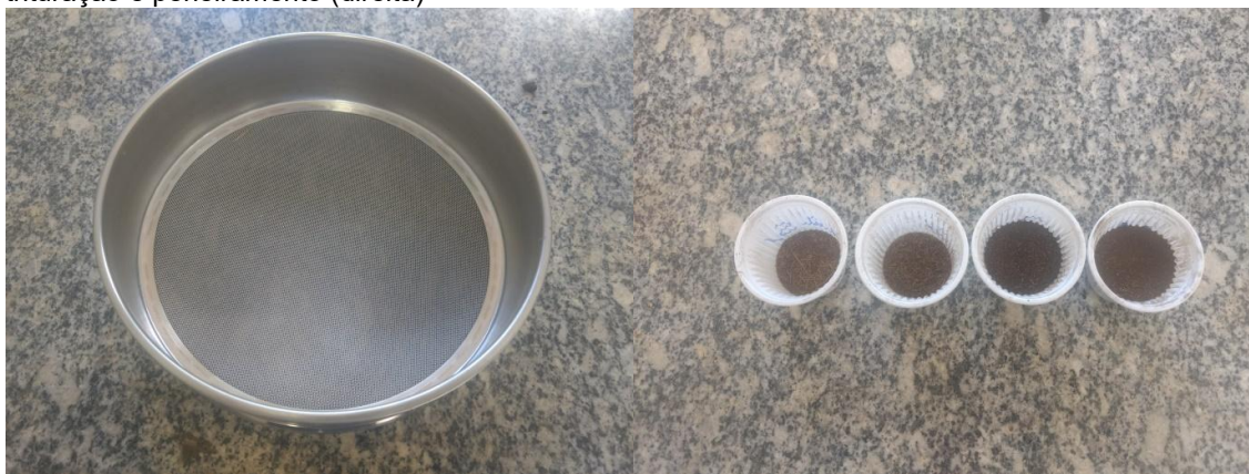
Figura 24 - Peneira granulométrica com abertura de 0,5 mm (esquerda) e amostras secas após trituração e peneiramento (direita)
