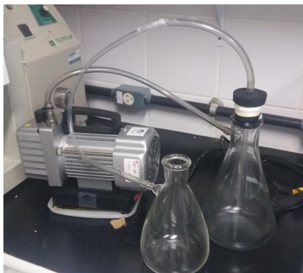
Figura 18: Filtro à vácuo utilizado no ensaio.
