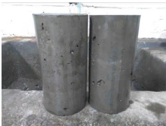
Figura 22: Corpos de prova produzidos com adição do resíduo.
