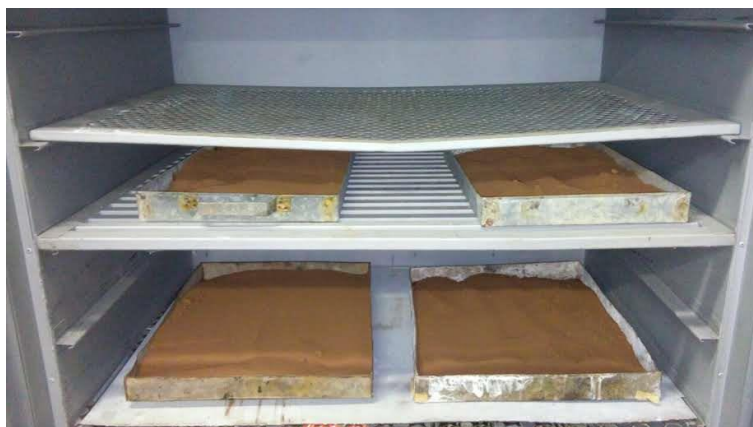
Figura 12: Resíduo passando pela secagem na estufa.
