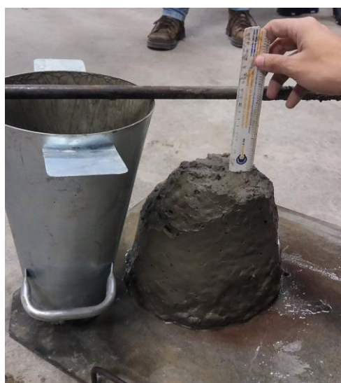
Figura 23: Ensaio de Abatimento pelo Tronco de Cone.
