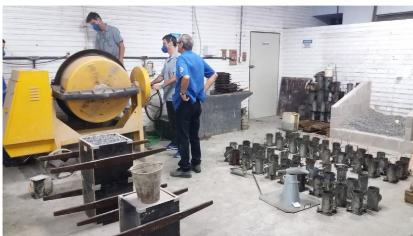
Figura 21: Produção dos concretos no LEMAC/UFES.
