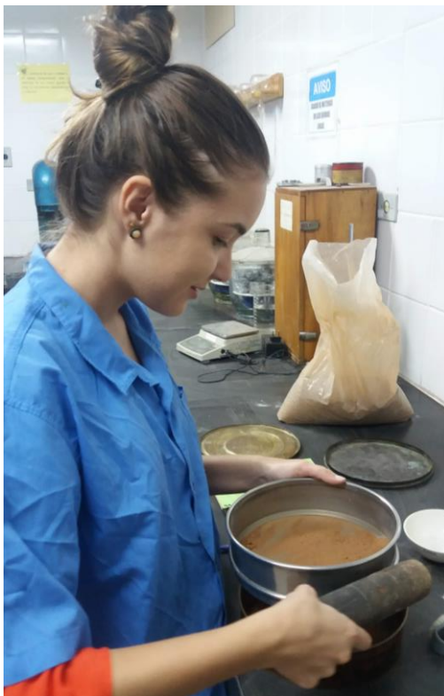
Figura 14: Ensaio de granulometria na peneira #200.
