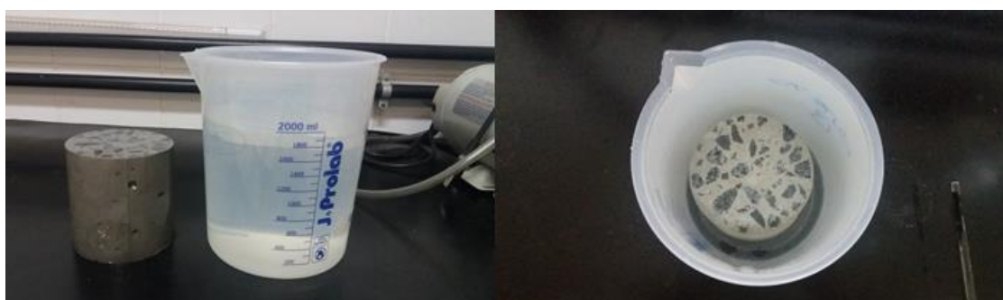
Figura 24: Corpo de prova e recipiente para o ensaio de lixiviação de metais em concretos.
