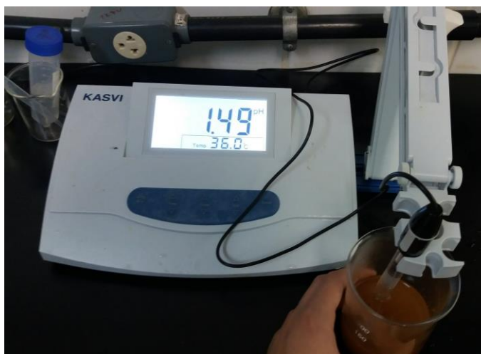
Figura 16: Determinação do pH do resíduo misturado à água.
