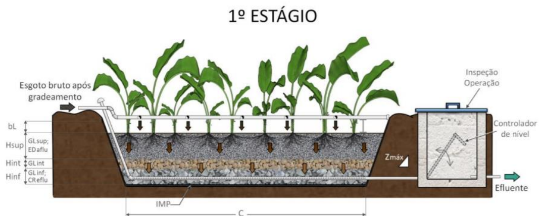
Figura 8 – Esquema representativo do perfil longitudinal do wetland construído do sistema francês
