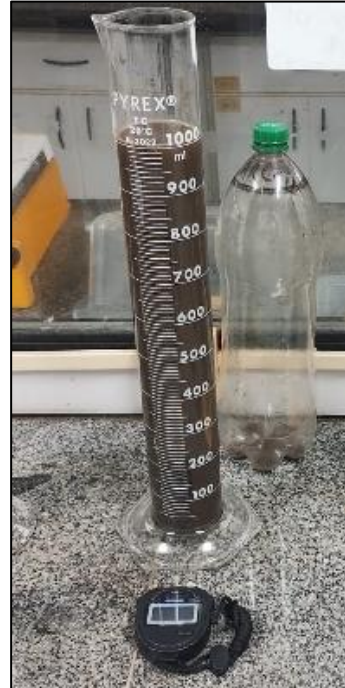
Figura 7 - Proveta graduada de 1000 mL e cronômetro digital utilizados no ensaio da taxa de sedimentação.
