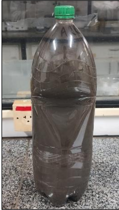
Figura 6 - Amostra da ARC armazenada em recipiente hermético de polietileno de 2 L após ser homogeneizada.
