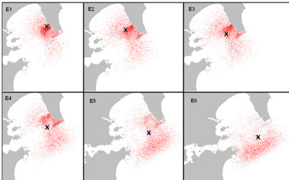
Figura 18: Distribuição das partículas 3 dias após o lançamento, para cada um dos pontos de emissão (E1 a E6). Simulação sem vento com lançamento na sizígia, com corrente e no período de sizígia.
